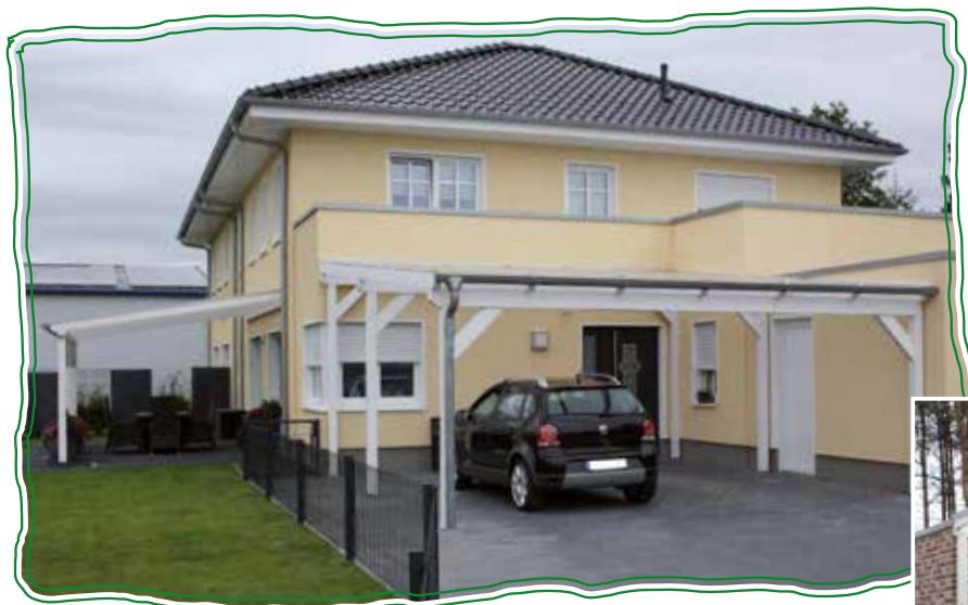
Rahmen KVH lasiert, Verkleidung Rhombusprofil, Sibir. Lärche unbehandelt, Dacheindeckg. verz. lackierte Stahlplatten, Anti-Tropfbeschichtet
