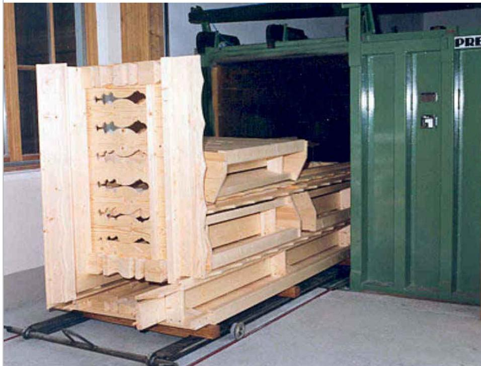
Bei dem so genannten Niederdruckverfahren wird das Holz zunächst einem schwachen und kurzen Vorvakuum ausgesetzt, dann wird die Anlage mit Lösungsmittellösung geflutet und auf Normaldruck entspannt. Dadurch wird die Lösungsaufnahme im Vergleich zur Kesseldruckimprägnierung deutlich reduziert. Im abschließenden Vakuum wird überschüssige Lösung entfernt und so eine recht „trockene“ Oberfläche des Holzes erzielt.
