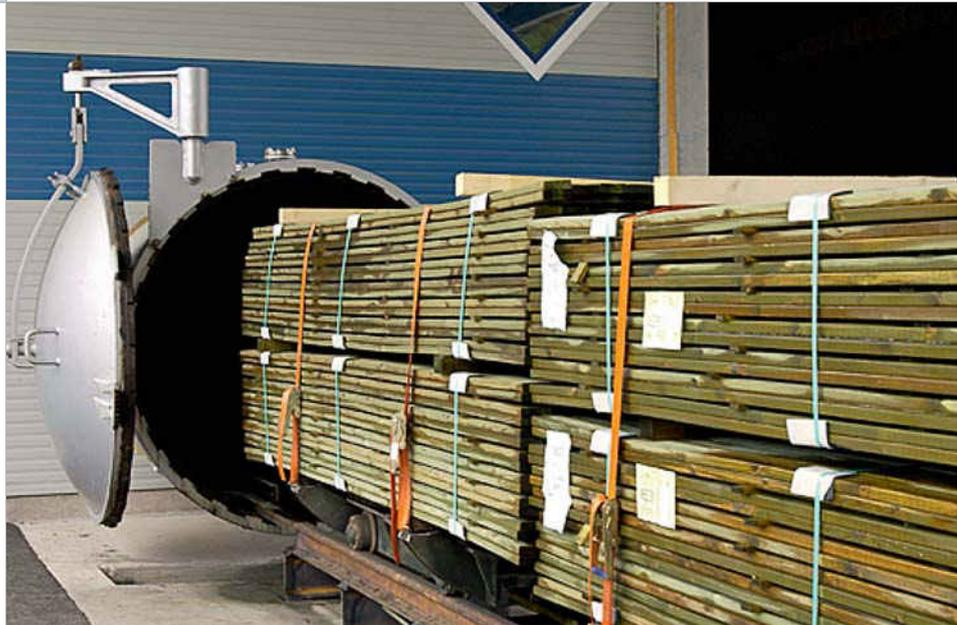
Starke Vakuumpumpen evakuieren den Imprägnierkessel und das darin befindliche Holz. Je besser das Vorvakuum, desto höher ist die zu erreichende Aufnahmemenge an Schutzmittellösung. Während des Flutens des Kessels mit Imprägnierlösung muss das Vakuum aufrechterhalten werden. Anschließend pressen Druckpumpen die Schutzmittellösung mit hohem Druck tief in das Holz.
