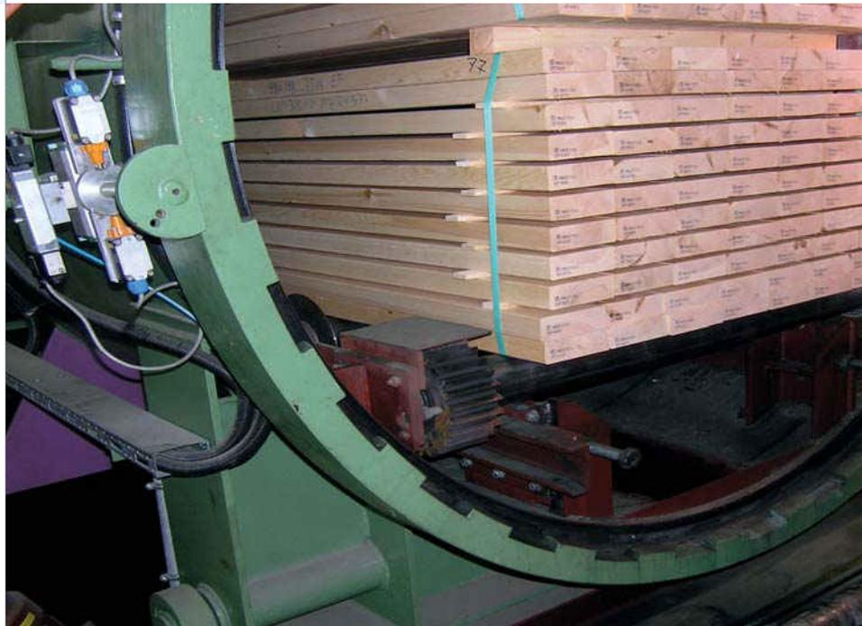
Der wirkungsvollste Schutz wird mit der sogenannten Vollzelltränkung erreicht. Dabei wird die Druckphase solange aufrechterhalten, bis das Holz keine Imprägnierflüssigkeit mehr aufnimmt. Die wichtigsten Verfahrensschritte für den Tränkerfolg sind das Vorvakuum, das Fluten des Kessels unter Vakuum und die Druckphase.
