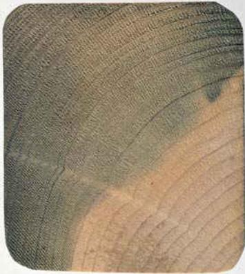
Die Anforderungen an nicht tragende Schnitthölzer in der Gebrauchsklasse 3 (NP 1: 0 mm bzw. NP 2: 3 mm) können auch mit Nichtdruckverfahren erfüllt werden, während die Anforderung NP 5 (komplette Splintdurchtränkung) für Schnitthölzer gut tränkbarer Holzarten in Gebrauchsklasse 3.2 nur im Kesseldruckverfahren möglich ist. Grundsätzlich ist die Behandlung von Schnittholz in GK 3 im Kesseldruckverfahren zu empfehlen.
