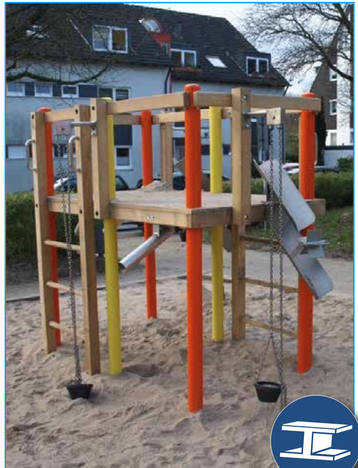
Sandbaustelle Dorsten Standpfosten aus Stahlrohr verz. u. lackiert, Sandschütten aus Edelstahlrohr, Bodenbeläge, Riegel u. Brüstungen aus Robinie
